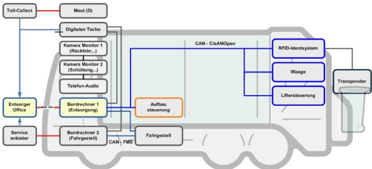
Diese Darstellung zeigt ein Müllsammelfahrzeug mit den möglichen verbauten Komponenten. Die aufgezeigten Schnittstellen, CleANopen, CAN-FMS, sind heutiger Standard. Die Darstellung ist nicht auf diesen Fahrzeugtyp beschränkt, sondern kann auch auf einen Abroller, Absetzkipper oder ein Saug-/Spülfahrzeug übertragen werden. Das Prinzip ist gleich: Fahrgestell, Aufbau, Aggregate.
